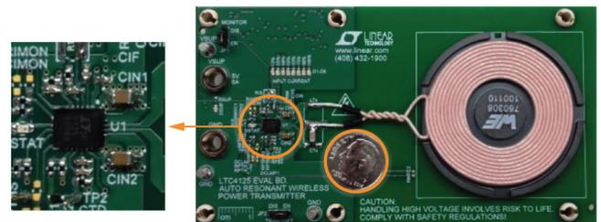
图6. 使用LTC4125的典型全无线功率发送器电路板。
